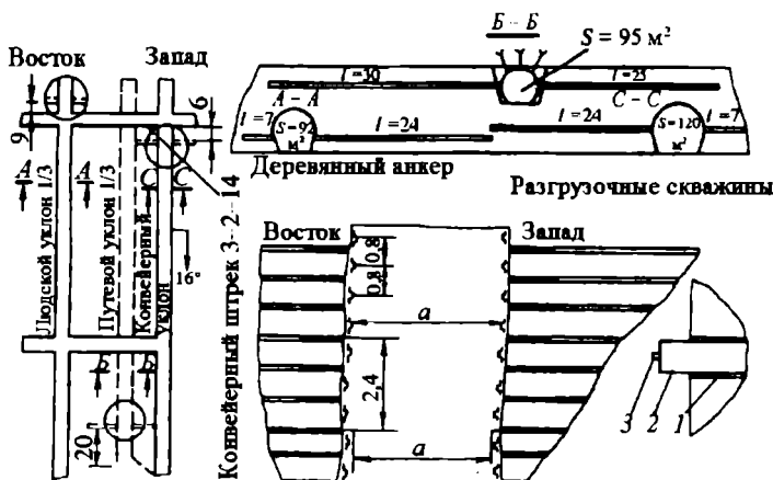
Рис. 2.21. Схема проведения эксперимента по анкерованию боков выработок с помощью деревянных стоек
